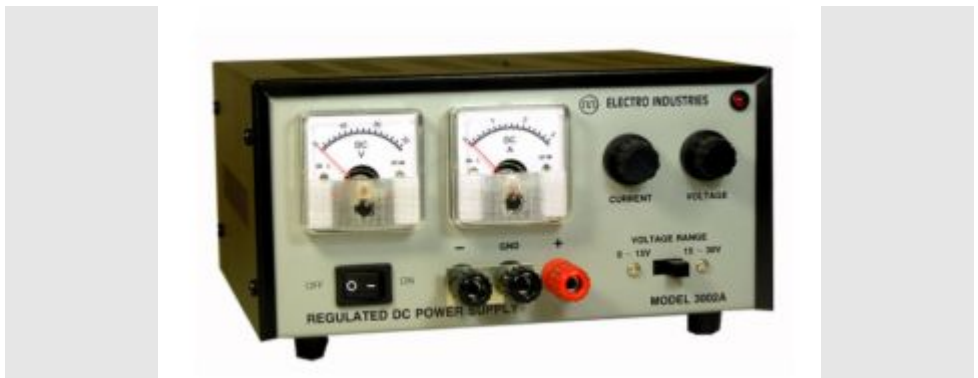
Figura 2 – Fonte de bancada com indicadores analógicos de tensão e corrente
