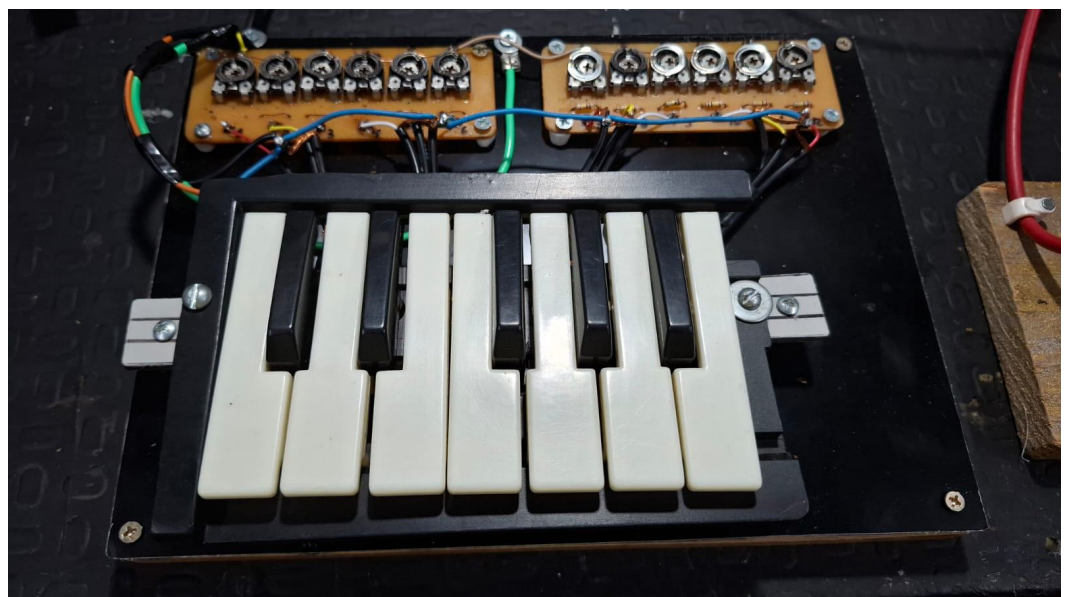
Figura 1 - Meu teclado é ajustado com um trimpot em cada uma das teclas.
