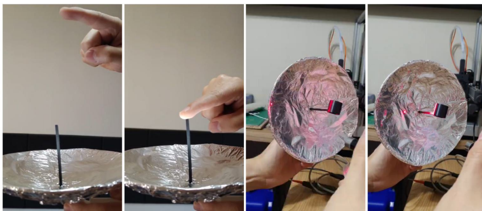
Figura 4 - Testando o foco de captação.
