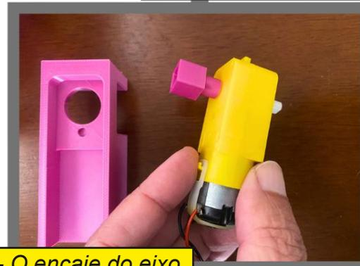
Figura 7 - O encaixe do eixo
