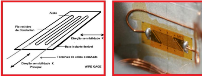
Figura 14 - Esquema funcionamento sensor
