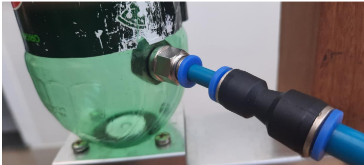
Figura 27 - Conexão pneumática no foguete
