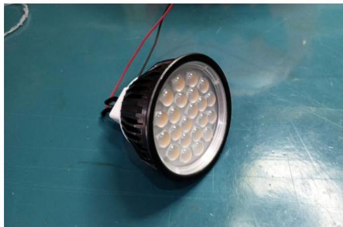
Figura 01 - Lâmpada LED dicróica 12V 5X
