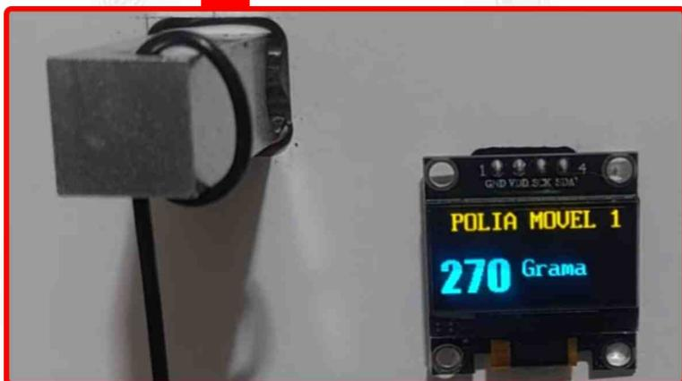
**Figura 04 - Célula de carga e display**
