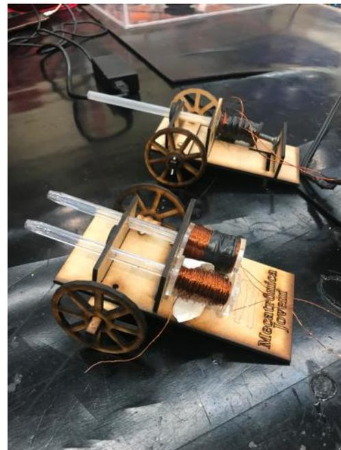
Figura 2 - Bobina acoplada na base.
