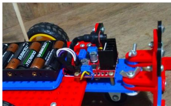
Figura 4 - Drive L298N instalado na frente do carrinho.
