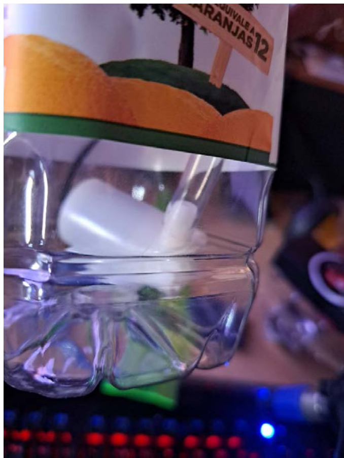
Figura 8 - A bomba d'água dentro da garrafa
