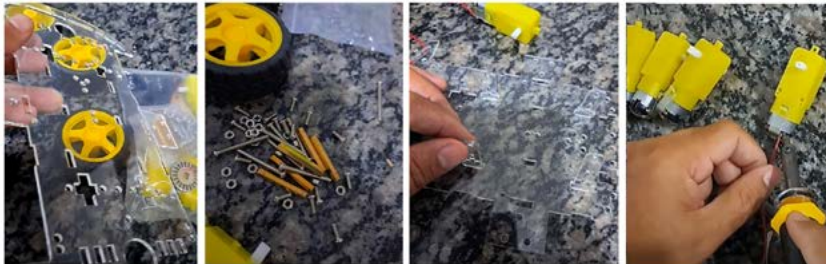
Figura 3 - Montando o Chassis e soldando o motor.
