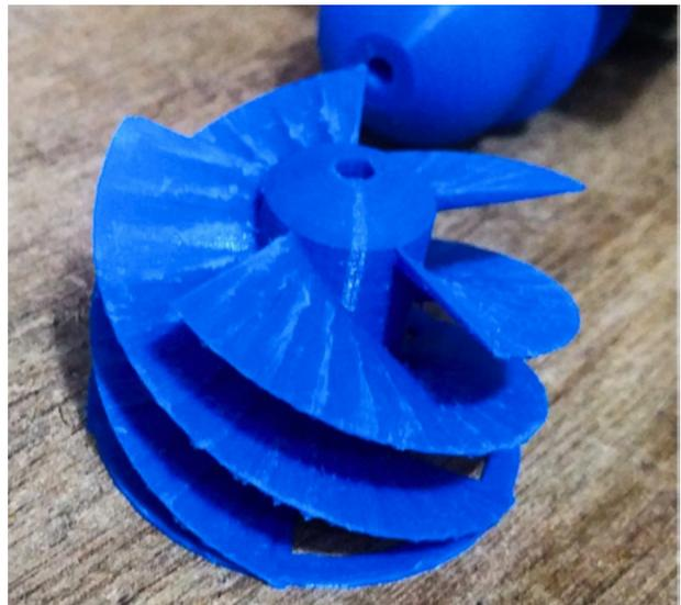
Figura 6 - Hélice de propulsão impressa na 3D.
