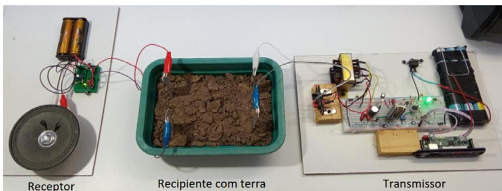
Figura 6 - Experimento montado na bancada do laboratório.
