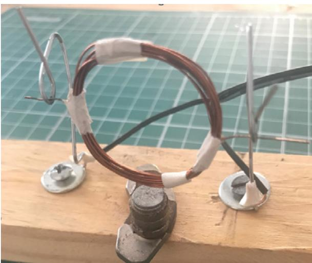
Fixe duas hastas metálicas na base de madeira, coloque o positivo do suporte de pilha em uma das hastas e o negativo em outra haste.
