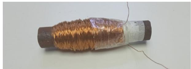
Figura 3 - Bobina com núcleo de barra de ferro.
