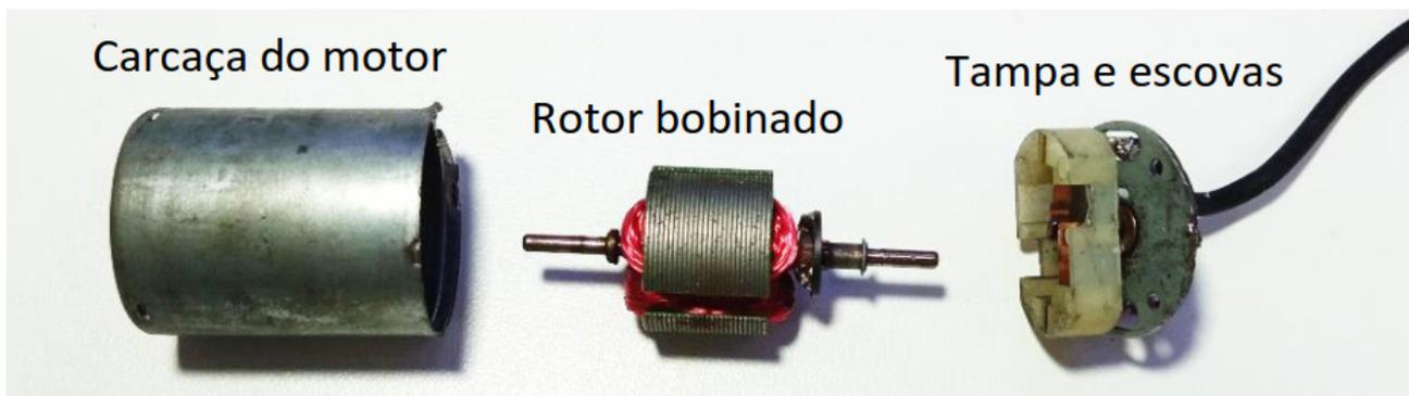
Figura 3 - Partes de um motorzinho desmontado. O que nos interessa é o rotor
