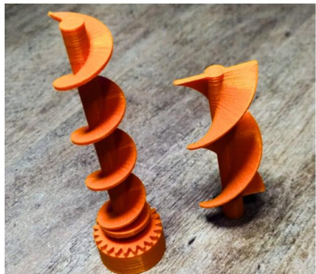
Figura 1 - Parafuso de Arquimedes impresso na 3D.
