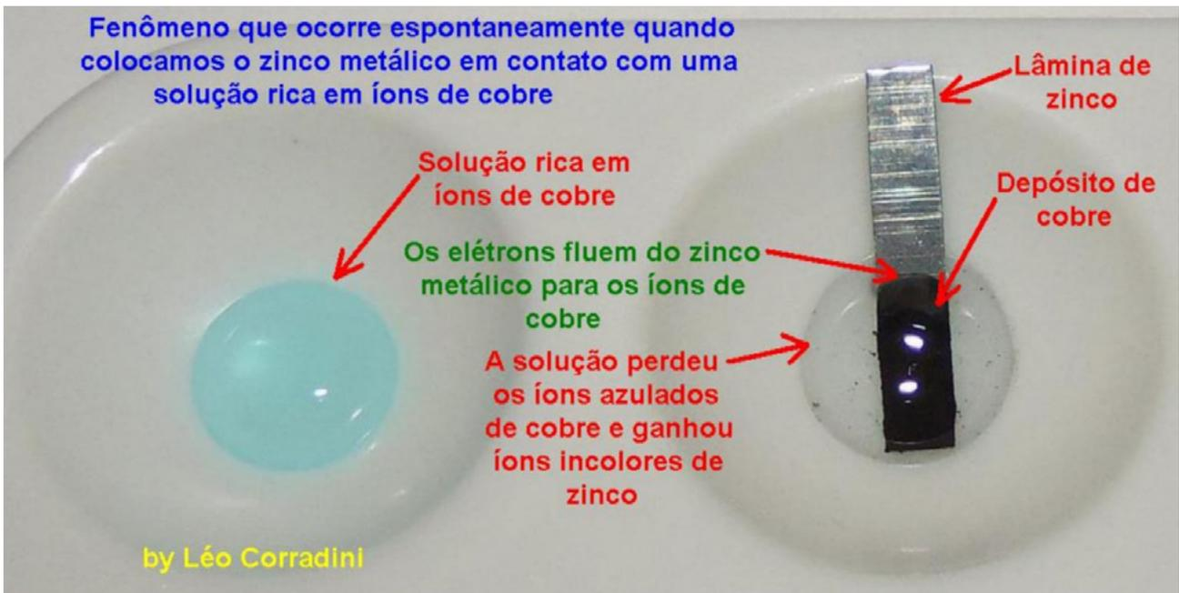
Figura 2 - Os elementos aplicados na construção da pilha para a explicação.
