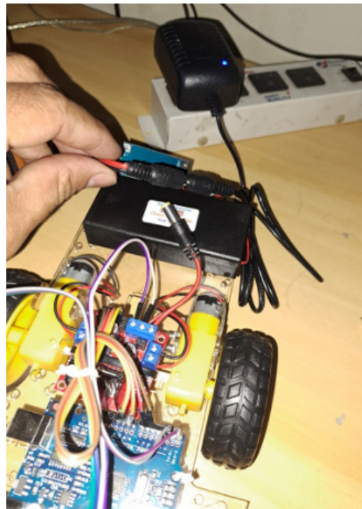
Figura 10 – Recarregando a bateria do nosso robô.
