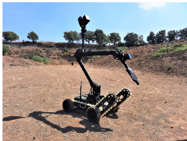
Figura 6 - EOD robot PIAP GRYF - Conjunto de duas esteiras e rodas para desarmar bombas. - Fonte: https://www.antiterrorism.eu/piap_summarizes_2021/
