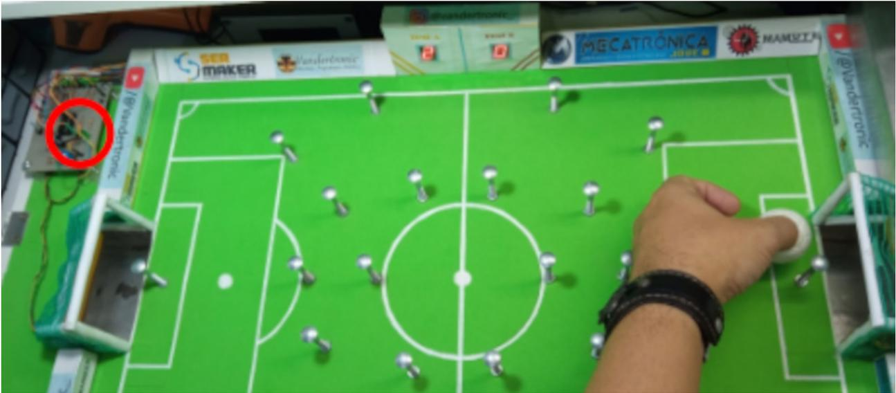
Figura 9 - Removendo a bola de dentro da trave, o led deverá apagar.
