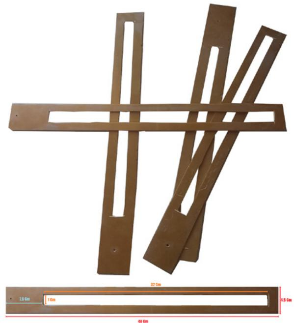
Figura 3 – Placas vazadas de fenolite e as medidas.
