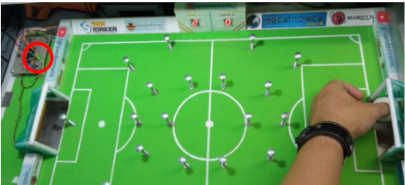
Figura 8 - Teste de alcance de detecção da bola dentro trave. Observe que a bola é colocada na trave adversária e o led do lado contrário, circulado em vermelho na foto, é que deve acender, bem como o placar deve marcar o gol.
