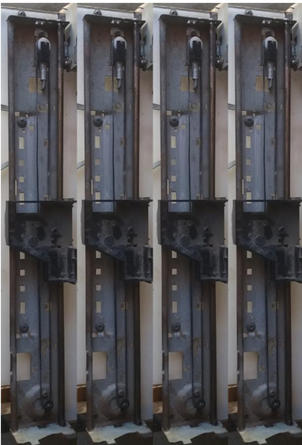
Figura 2 – Bases de impressoras com motores.
