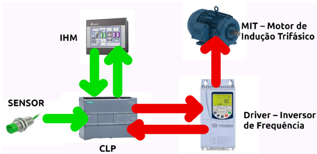
Figura 7 - Etapas de um controle de automação
