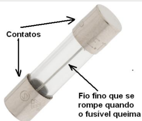
Figura 2 - Estrutura de um fusível comum
