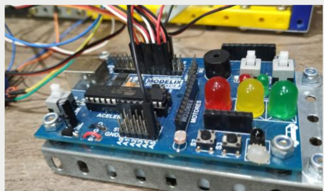
Figura 13 - Placa de desenvolvimento Modelix, compatível com a Duemilanove.
