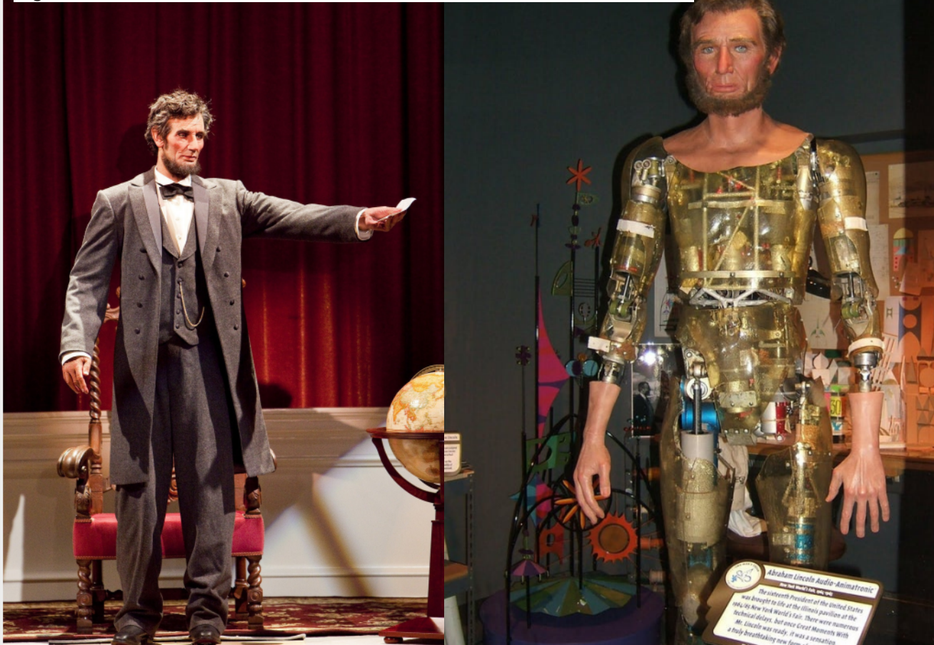
Figura 1 - Áudio-animatrônico do Abraham Lincoln e detalhes internos
