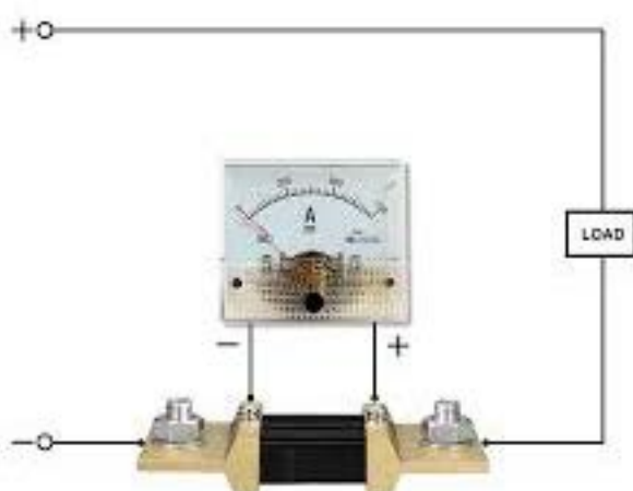
Figura 4 – Shunt num instrumento analógico para medida de alta corrente
