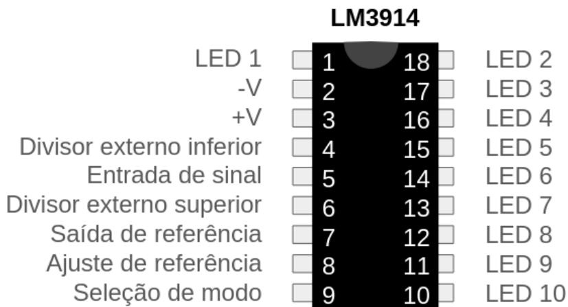
Figura 2 - Invólucro DIL de 18 pinos, o mais comum para o circuito integrado LM3914.
