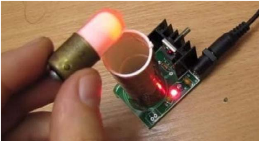
Figura 1 – Brilho de uma lâmpada de neon em um campo de correntes de alta frequência
