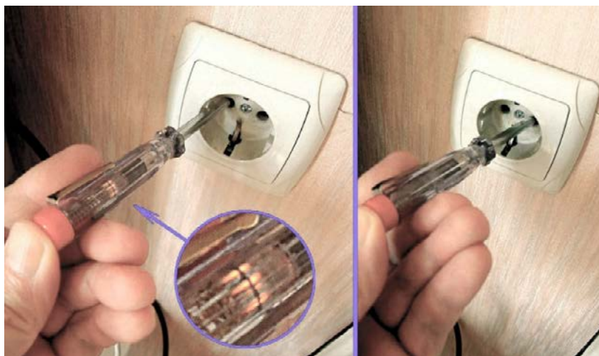
Figura 9 - Usando uma chave de fenda indicadora baseada em lâmpada neon para indicar o fio de fase
