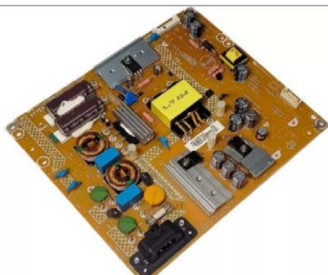
Figura 2: placa da fonte de alimentação de uma Smart TV
