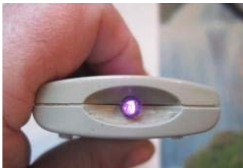
Figura 7: visualização da luz infravermelha através da câmera de um aparelho celular.
