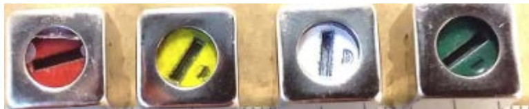
Figura 6 – Cores das bobinas de um rádio AM (código Toko)
