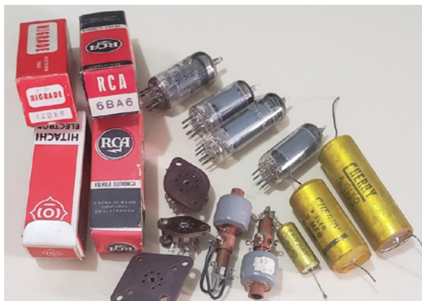
Figura 2 - Válvulas, soquetes de válvulas, capacitores típicos de óleo e bobinas de um rádio desse tipo.
